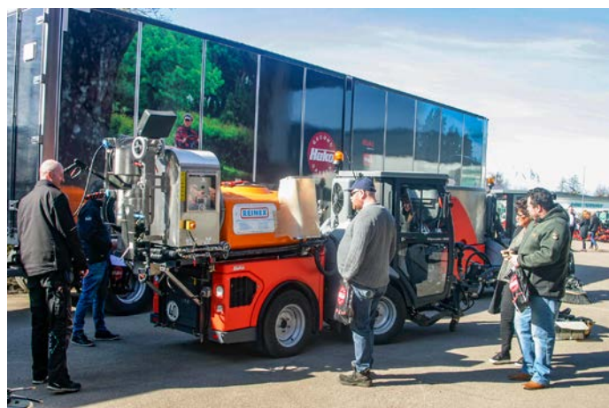
Med ånga och högtryck avlägsnar den här maskinen inte bara smuts. Den tar också effektivt och miljövänligt död på allt ogräs som kommer i dess väg.
