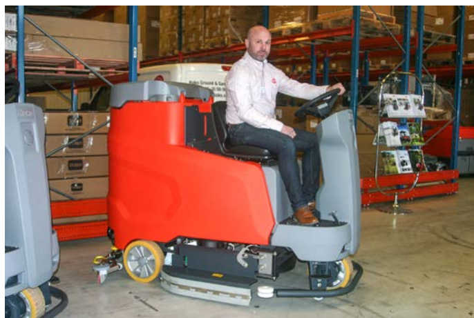
Scrubmaster B175 R är en nykonstruerad städmaskin med smarta städrondeller, som med en arbetsbredd på 1 080 mm effektivt plockar upp allt skräp. Det berättade Magnus Pettersson, ansvarig för affärsområdet städ på Hako.
