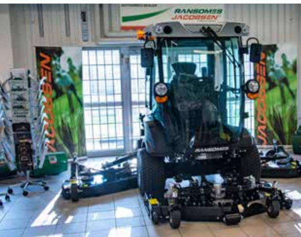
Rotorklipparen Ransomes MP653 har inte några remmar utan istället en klippmotor till varje kniv. Dessutom är förarplatsen ISO-monterad för att minska vibrationer hos föraren. Klippbredder finns från 3 till 4,2 meter.
