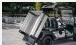
Lastflak i aluminium med fällbar baklucka.
