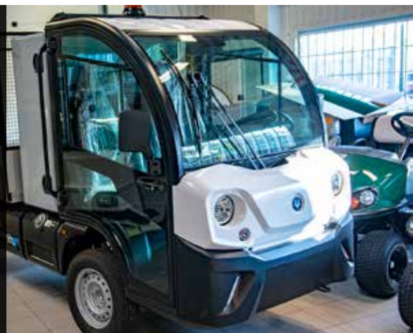
Goupil G4 är ett kompakt elfordon för professionellt bruk. Det har ett litiumbatteripaket på 12 kWh och en körsträcka på upp till 135 km. Elsystemet är anpassat för körning med många korta stopp. Modellen kan specialanpassas för olika ändamål.
