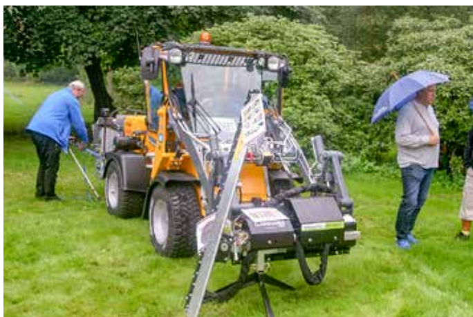
Bengt Bergs Maskinservice visade en häcksax från Ystama-skiner med snabbfäste, skjutbar i sidled och som kan vinklas för att komma åt överallt. Den är här kopplad till Wille redskapsbärare.
