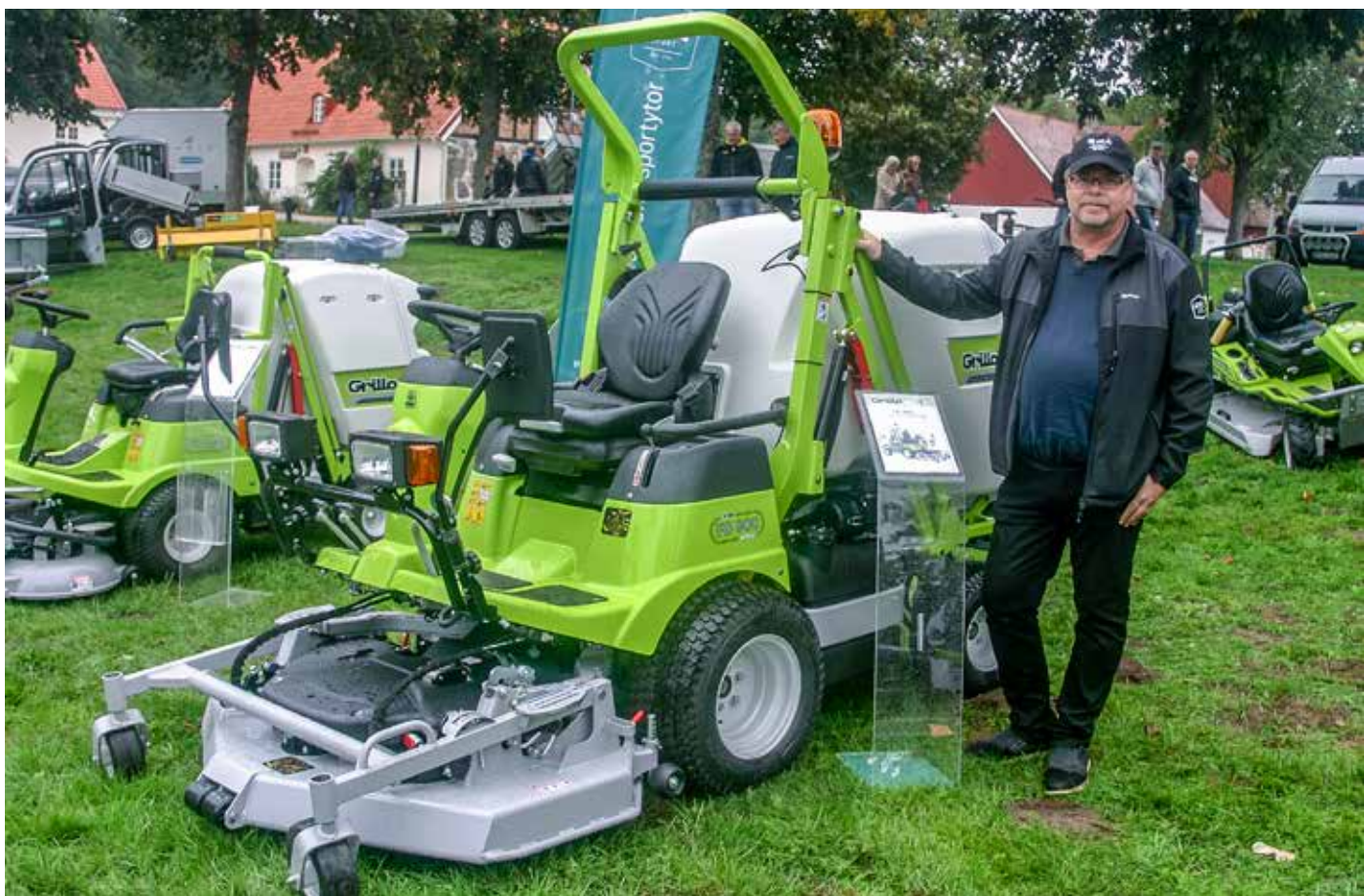
Anders Nilsson, GML , kunde presentera en ny mellanmodell av Grillo med ett klippdäck på 126 cm. Maskinen har lånat teknik från de större systermodellen i familjen, bl.a. fläktförstärkt uppsamling, avancerat klippdäck och hydraulisk reglering direkt från förarplats. Högtippande, upp till 1950 mm. Motor: 26 hk. Hastighet: max 14.5 km.
