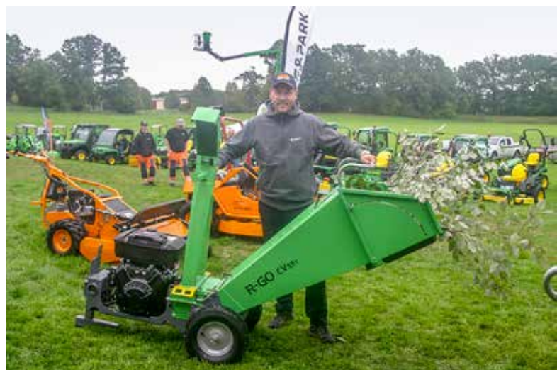
Kompakta flismaskinen R-GO tillhörde också nyheterna på mässan. Den har bred och rymlig inmatning, är lätt att transportera men ändå kraftfull med två justerbara högkvalitetsknivar. Drivs av en tvåcylindrig fyrtakts Vanguardmotor på 16 alternativt 18 hk. Max klippdiameter 11 resp. 13 cm. Max spridning 6-8 meter från det justerbara utkastet, berättar Christian Hjortmar på Stads & Parkprodukter .
