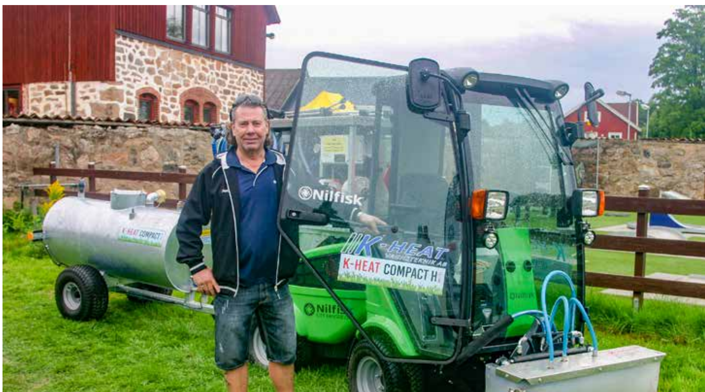
Jatte Westerblad från Nils Larssons Maskin i Helsingborg presenterade en uppfinning som framtagits i samarbete med K-vagnen . Det är ett redskap för ogräsbekämpning och högtryckstvättning, specialbyggt för redskapsbäraren City Ranger 2250 . Det datorstyrda aggregatet kan enkelt kopplas bort så att redskapsbäraren kan användas för andra uppgifter.
