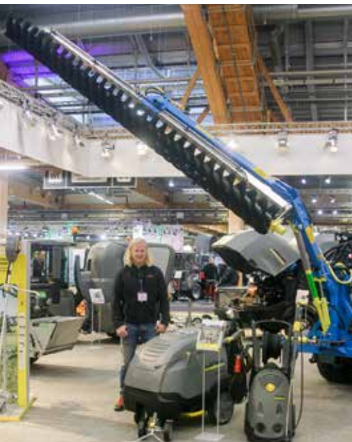
Med denna Sunbrush som tillhör till Belos Trans Giant kan solpaneler tvättas rena från beläggningar som hindrar elproduktionen, visar Thomas Sällström från Markvårdsmaskiner i Kungälv.
