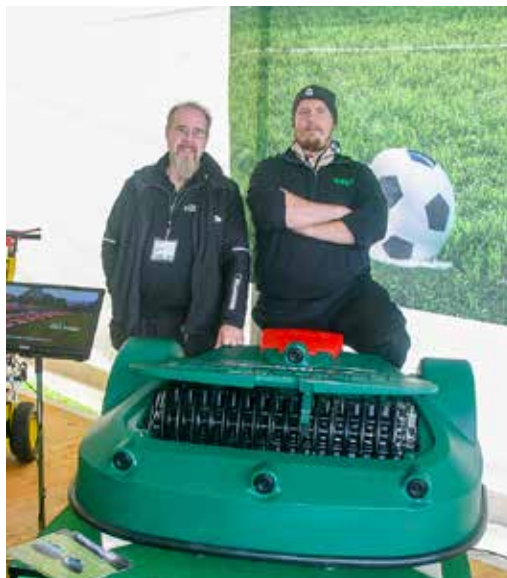
En ny förbättrad version av Bellrobotics Ball-picker visades av Mats Jansson, RoboCare och Tobias Persson, Tidab . Den klarar att plocka 300 bollar på en driving range innan den går tillbaka för tömning och laddning, men plockar också eventuella bollar på den GPS-styrda tillbakavägen.
