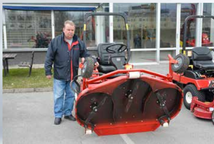
Håkan Mattsson, tidigare generalagent för Shibaura i Sverige, var med på visningen. Här visar han ett klippaggregat från italienska Caroni som är anpassat efter den svenska marknadens önskemål. Det har hydraulisk höjdställning och går att förskjuta 3 dm i sidled och passar bra till Shibauras klippare.
