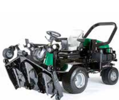
Ransomes HR300 Kubota diesel 33 hk miljösteg IIIA. 150-180 cm klippbredd
