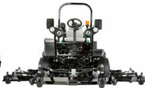
Ransomes MP493 Kubota diesel 49 hk miljösteg IIIA. 300-330 cm klippbredd
