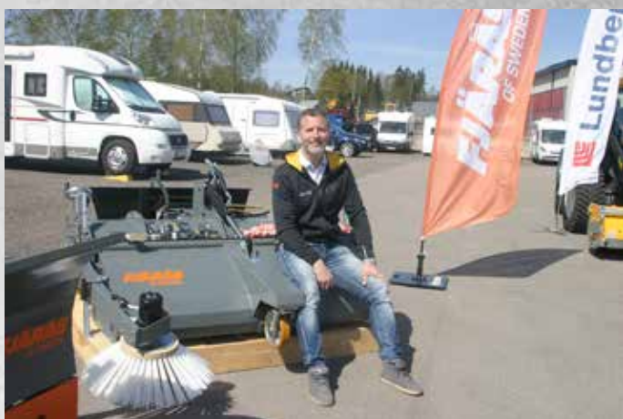
Joakim Barck från Fjärås i Ljungskile visade upp det här frontmonterbara sopaggregatet. Säljs i moduler, med eller utan sidoborste, vatten och uppsamlare. Arbetsbredder från 1 300 till 2 200 mm.
