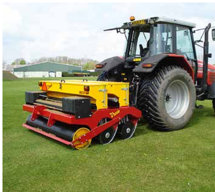
Vredo såmaskiner genererar en grobarhet upp till 96 procent tack vare det patenterade och V-formade Dual-Disc-systemet.
